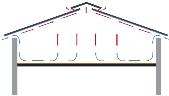
*Ausreichende Belüftung in einem isolierten Gebäude mit Lufteinlass an den Seiten und Luftauslass durch den Dachfirst.*
