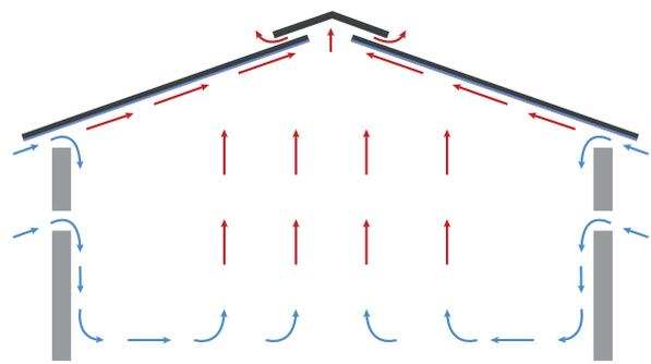
*Ausreichende Belüftung in einem nicht isolierten Gebäude mit Lufteinlass an den Seiten und Luftauslass durch den Dachfirst.*
